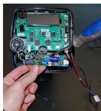
FIXER LA CARTE ÉLECTRONIQUE DU GÉNÉRATEUR DE CHLORE AVEC LES DEUX VIS EN DOTATION
